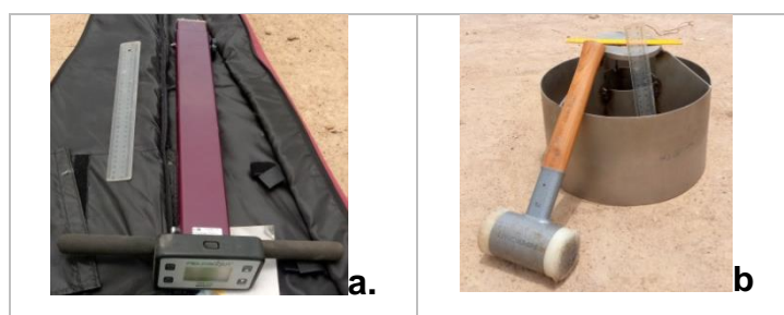
Fig. 2. Matériel d'étude du sol. a. Humidimètre TDR 350 ; b. Infiltrmètre à double anneau
